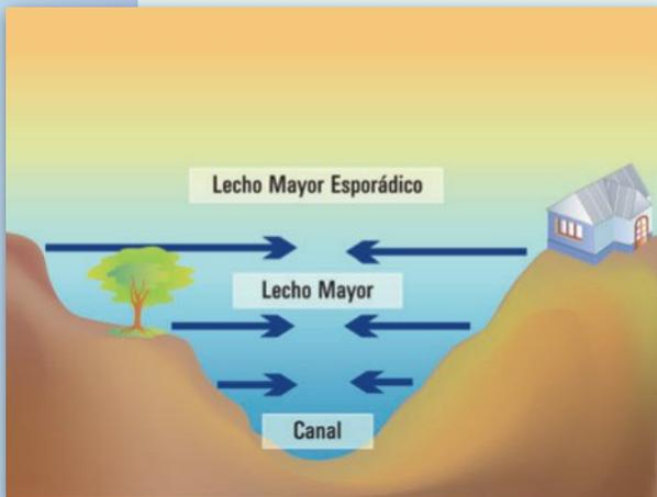
Figura 7: Perfil transversal típico de un río.
